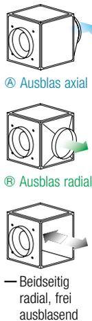
Beliebige Einbaulage und Aufstellung durch fünf mögliche Ausblasrichtungen.
