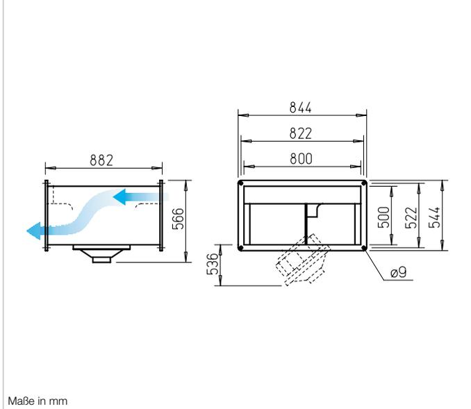
**Radial-Kanalventilatoren mit vorwärts gekrümmten Laufradschaufeln. Motor-Laufradeinheit ausschwenkbar.**
